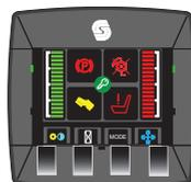
Questa schermata compare quando la chiave di accensione viene portata nella posizione di avviamento. Il freno di stazionamento deve essere inserito, l'interruttore degli apparati di taglio deve essere in posizione OFF e il pedale in folle. In queste condizioni, quando l'operatore si siede sul suo sedile, il motore può essere avviato.
