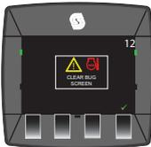
Quando compare questa schermata, significa che la temperatura del motore è salita oltre il livello normale. Spegner il motore e pulire le griglie del radiatore.
