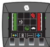
Questa schermata mostra l'interruttore degli apparati di taglio in posizione OFF, i blocchi di trasferimento inseriti, il sistema TST in funzione e la modalità di velocità.
