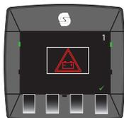
Quando appare questa schermata significa che la batteria non si sta caricando o che si è verificata una avaria del circuito di ricarica.
