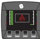
Se la pendenza raggiunge i 25°, sul display appare un avviso indicante che a 25° il piatto di taglio anteriore verrà sollevato di 10-15 cm dal terreno per migliorare la stabilità e tutti gli apparati si arresteranno. Viene anche emesso un segnale acustico quattro volte ogni 4 secondi e i LED rossi cominciano a lampeggiare con la stessa cadenza. Questa condizione perdura finché la macchina non viene portata su una superficie con pendenza inferiore a 16°.
