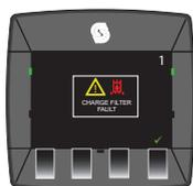
Quando viene mostrata questa schermata, significa che il filtro di ricarica idraulica è bloccato e deve essere sostituito. Sostituire il filtro appena possibile.
