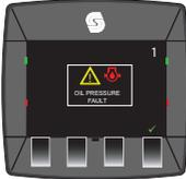
Quando compare questa schermata, significa che la pressione dell'olio motore è scesa sotto il livello normale. Se ciò succede durante il funzionamento o perdura anche quando il regime di rotazione del motore supera i 1000 giri/min, spegnere il motore e verificare il livello dell'olio. Rabboccare all'occorrenza.
