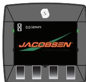
Questa schermata compare quando la chiave di accensione viene portata nella posizione di avviamento. Il contatore indica il numero complessivo di ore di funzionamento del motore.
