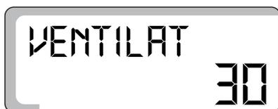
Appare "VENTILAT" seguito dal tempo di ventilazione impostato in minuti.
