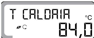
Sul display viene visualizzata la sonda di temperatura di cui si è premuto il tasto e si illumina il LED corrispondente, ad es. la temperatura della caldaia in °C, come nella visualizzazione qui accanto.
