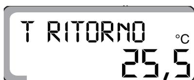
Come primo valore viene visualizzato sul display "T RITORNO" e la temperatura misurata.
