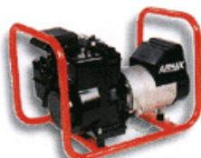
Macchina alimentata da un motore a scoppio destinata alla produzione di energia elettrica per l'alimentazione di attrezzature ed utensili del cantiere.
