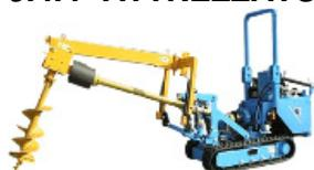
Trattasi di attrezzatura/macchina utilizzata per l'esecuzione di fori sul terreno, per palificazioni e paratie o per l'inserimento delle gabbie di armatura dei pali con l'ausilio dell'organo di servizio.
