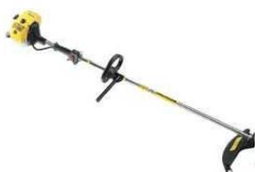
Il decespugliatore è un attrezzo utilizzato per tagliare cespugli, arbusti ed erba in luoghi non accessibili con altre macchine. Viene portato a tracolla o a spalla dall'operatore ed è dotato di motore di tipo elettrico o endotermico a due tempi, alimentato mediante una miscela benzina-olio, con cilindrata variabile, a seconda dei modelli, da 18 a 50 cc. Il motore, tramite un albero di trasmissione posto all'interno di un'asta, aziona un disco dentato o un rotore che sostiene due fili di nylon.
