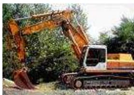
Macchina operatrice semovente su cingoli o ruote gommata, spinta da un motore endotermico diesel e dotata di un braccio articolato alla cui estremità viene montata una benna.
