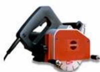
La scanalatrice per muri ed intonaci è un utensile alimentato elettricamente, utilizzato per la realizzazione di impianti sotto traccia, o per la rimozione di strati di intonaci ammalorati.
