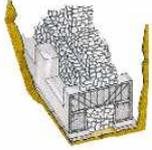
Trattasi di una tipologia di intervento di consolidamento delle fondazioni in cui viene realizzata una struttura di collegamento alla fondazione esistente e in testa ai micropali precedentemente realizzati
