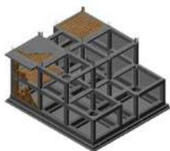
Trattasi della realizzazione di strutture in conglomerato cementizio del tipo tradizionale, per la realizzazione di setti, colonne, solette e scale. Si contemplano le seguenti attività:
