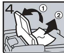
4. Se non è possibile rimuovere l'originale non alimentato correttamente, aprire il coperchio esterno dell'alimentatore originali (ADF), quindi rimuovere l'originale non alimentato correttamente.
