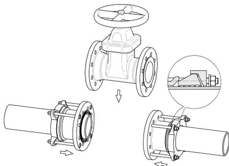
Non è necessario smontare il giunto ma è sufficiente allentare i dadi senza asportare le viti, assicurarsi che la guarnizione sia pulita ed integra. Centrare il giunto sull'area di montaggio. Attenzione le punte dei tubi dovranno risultare a  $-5+0$  mm. della flangia di giunzione. Serrare leggermente la viteria controllando il centraggio sulla tubazione. Inserire l'accessorio flangiato regolando eventualmente il giunto. La regolazione non dovrà superare i 10 mm
