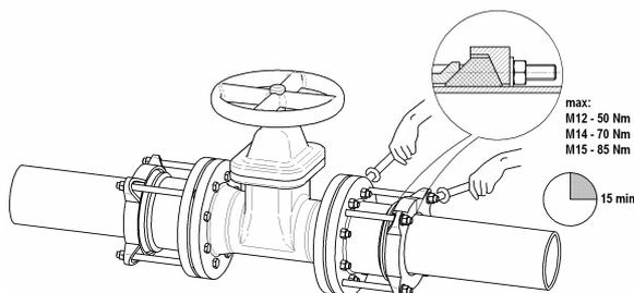
E' necessario sorreggere l'accessorio flangiato in modo che il suo peso non comprometta la centratura e la tenuta del giunto, serrare i dadi a croce, fino al valore raccomandato\*. Eseguito il montaggio controllare la tenuta del pezzo. Se necessario serrare ulteriormente. Non procedere all'immediato reinterro del pezzo ma ricontrollare la tenuta e il serraggio dopo 24 ore
