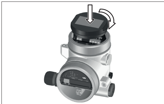
Figura 15: Inserzione del tastierino di taratura con display
