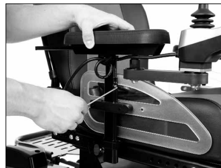
Fig. 11 Adattamento del bracciolo alla lunghezza del braccio
