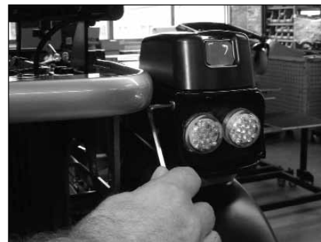
Fig. 54 Fissaggio dell'impianto di illuminazione posteriore al braccio oscillante
