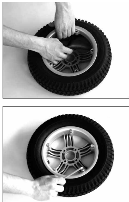
Fig. 53 Smontaggio del copertone
