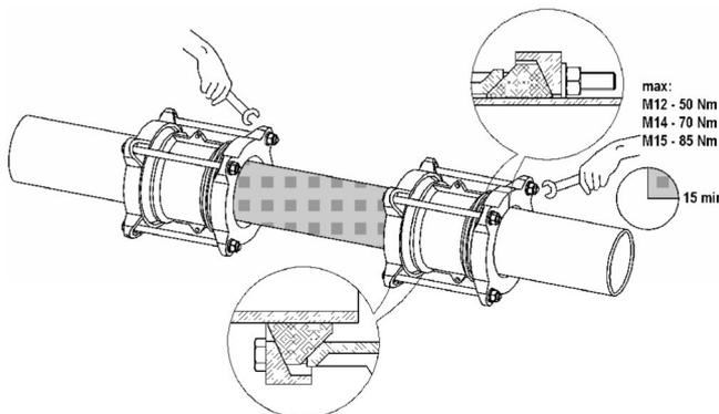
Serrare i dadi a croce, fino al valore raccomandato\*. Eseguito il montaggio controllare la tenuta del pezzo. Se necessario serrare ulteriormente. Non procedere all'immediato reinterro del pezzo ma ricontrollare la tenuta e il serraggio dopo 24 ore
