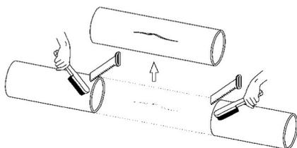
Verificare esattamente il diametro esterno della tubazione e accertarsi che esso sia compatibile con il collare che si intende montare. Procedere ad un accurata pulizia della parte di tubazione su cui andrà applicato il pezzo
