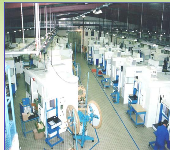
**Le coperture integrali possono garantire un potere fonoisolante di 20÷30 dB**
