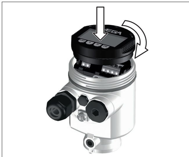
Figura 21: Inserimento del tastierino di taratura con display nel vano dell'elettronica in caso di custodia ad una camera
