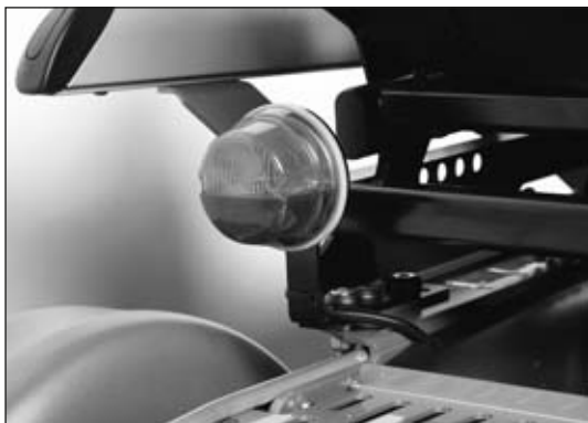
fig. 20 Impianto di illuminazione posteriore
