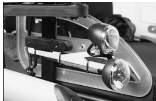
fig. 19 Impianto di illuminazione anteriore
