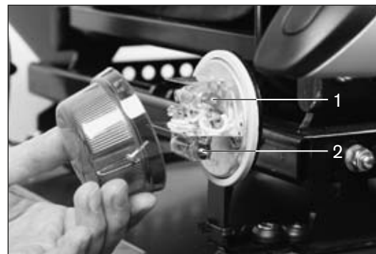
fig. 42 Smontaggio dell'impianto di illuminazione posteriore
