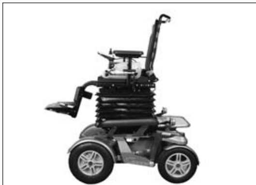
III. 24 C2000 avec dispositif de réglage en hauteur du siège déployé
