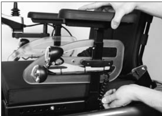
III. 9 Desserrage de la vis papillon pour démonter le protège-vêtements doté de l'accoudoir
