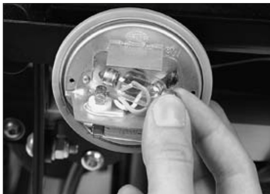
III. 43 Remplacement de l'ampoule de clignotant
