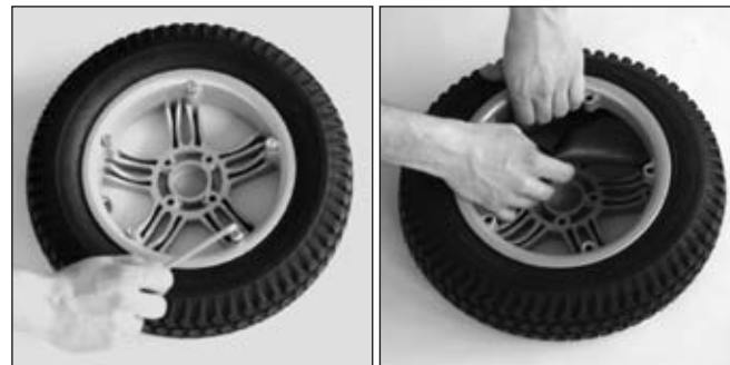
fig. 39 Smontaggio del copertone
