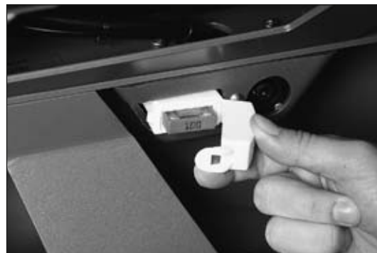
Ill. 36 Remplacement du fusible
