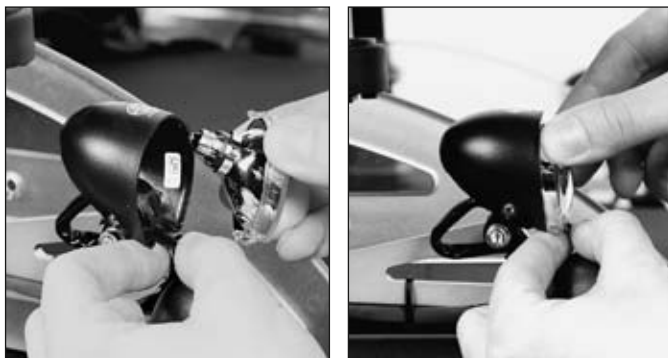
III. 40 Remplacement de la lampe halogène des feux avant
