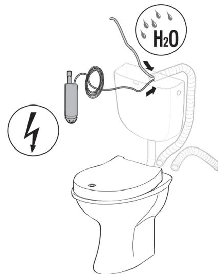
5 Collegare il tubo completo di raccordo a "T" alla pompa ed il tubo lungo al raccordo.
