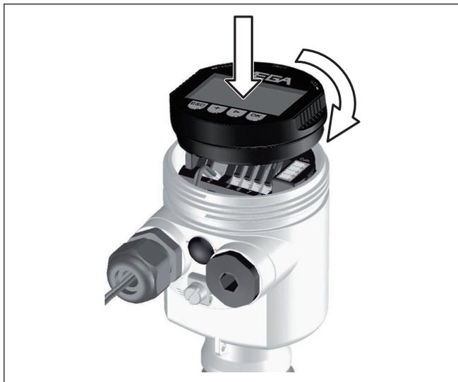
Figura 20: Installare il tastierino di taratura con display
