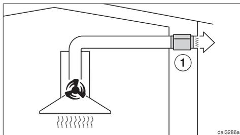
L'insonorizzatore riduce i rumori del ventilatore verso l'esterno e anche i rumori esterni che entrano in cucina attraverso il tubo di evacuazione (ad es. rumori del traffico). L'insonorizzatore va installato possibilmente in prossimità dell'uscita di sfiato ①.
