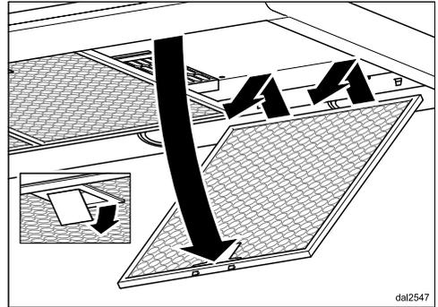
■ Aprire il dispositivo di chiusura dei filtri antigrasso, abbassare il filtro di circa 45°, sganciarlo sulla parte anteriore e toglierlo di sede.
