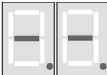
Figura 9: Indicatore "- -" - cancellazione di un trasmettitore radio
