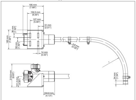
Figura 28: FIBERTRAC 31 con accessori di montaggio in dotazione
