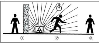
Figura 2: Provvedimenti per la protezione da fonti radioattive
