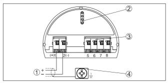
Figura 10: Vano di calibrazione e connessione (Ex-ia) per apparecchi con uscita in corrente a sicurezza intrinseca
