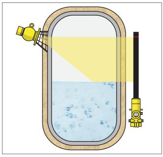
Figura 5: Misura di livello su un serbatio riscaldato con isolamento termico
