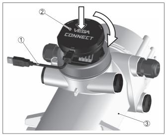
Figura 19: Collegamento diretto del PC al sensore via adattatore d'interfaccia
