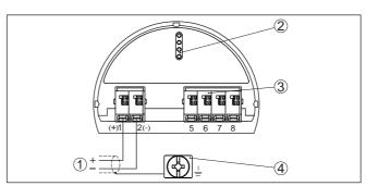
Figura 14: Vano di calibrazione e connessione (Ex-ia) per apparecchi con uscita in corrente a sicurezza intrinseca
