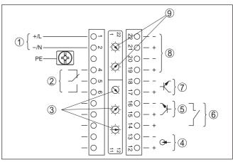
Figura 9: Vano dell'elettronica e di connessione (Ex-d) per apparecchi con uscita in corrente a sicurezza intrinseca
