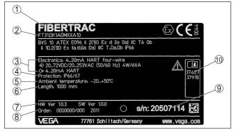
Figura 1: Struttura della targhetta d'identificazione (esempio)
