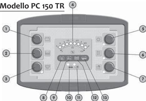
tasto 1 : Pulsante per il controllo della batteria servizi (B2) e della batteria motore (B1). *Premendo una prima volta, abbiamo il carico de la batteria B1 e premendo una seconda volta quella della batteria 2.*
