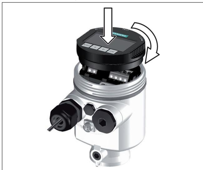
Figura 20: Inserimento del tastierino di taratura con display nel vano dell'elettronica in caso di custodia ad a camera
