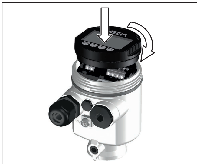
Figura 25: Inserimento del tastierino di taratura con display nel vano dell'elettronica in caso di custodia ad una camera
