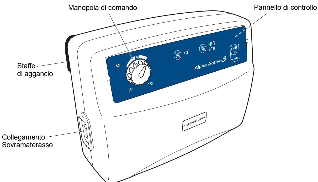
I comandi sono situati sul lato anteriore della pompa. Un sofisticato sistema di allarme è in grado di distinguere tra errori del normale funzionamento e guasti reali del sistema. La presenza di una condizione di allarme provoca l'immediata accensione della spia sul lato anteriore della pompa nonché l'emissione di un segnale d'allarme.
