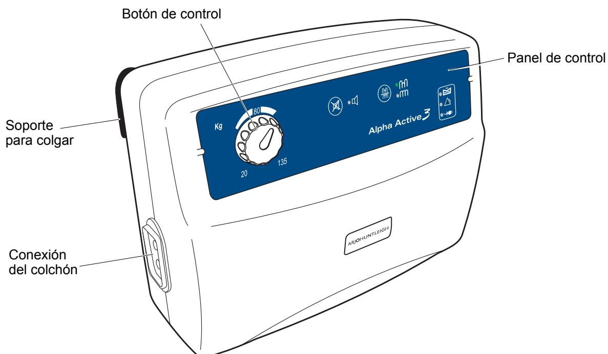
Los controles están situados en la parte frontal del compresor. Un sofisticado sistema de alarma distingue entre el funcionamiento normal y las averías del sistema. Si se detecta una situación de alarma, se emitirá un aviso sonoro y se encenderán los indicadores situados en la parte frontal del compresor.
