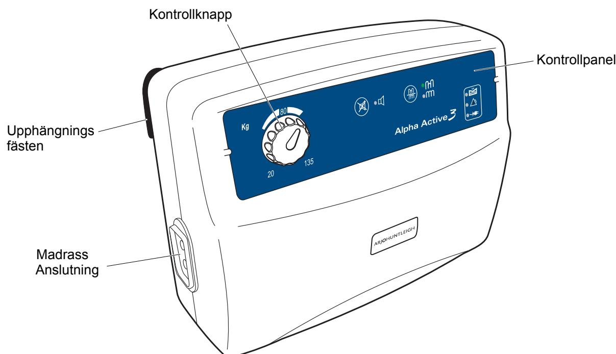
Kontrollerna sitter på pumpens framsida och ett sofistikerat larmsystem urskiljer normal drift och genuina systemfel. Om en larmsituation detekteras tänds en indikatorlampa på pumpens framsida och en ljudvarning hörs.
