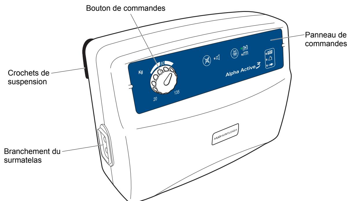
Les commandes sont situées sur la façade de la pompe et un système d'alarmes sophistiqué fait la différence entre un mode de fonctionnement normal et des réels problèmes de fonctionnement. Si une situation d'alarme est détectée,
