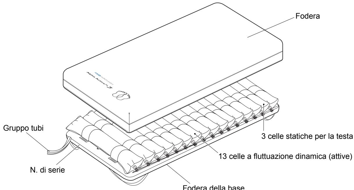
**Fodera rimovibile** La fodera standard è costituita da tessuto in PU elastico, fissato tramite cerniera ad una base resistente in nylon. Le cerniere sono protette da alette che impediscono l'ingresso di elementi contaminanti e che consentono un'agevole rimozione della fodera per la pulizia.
