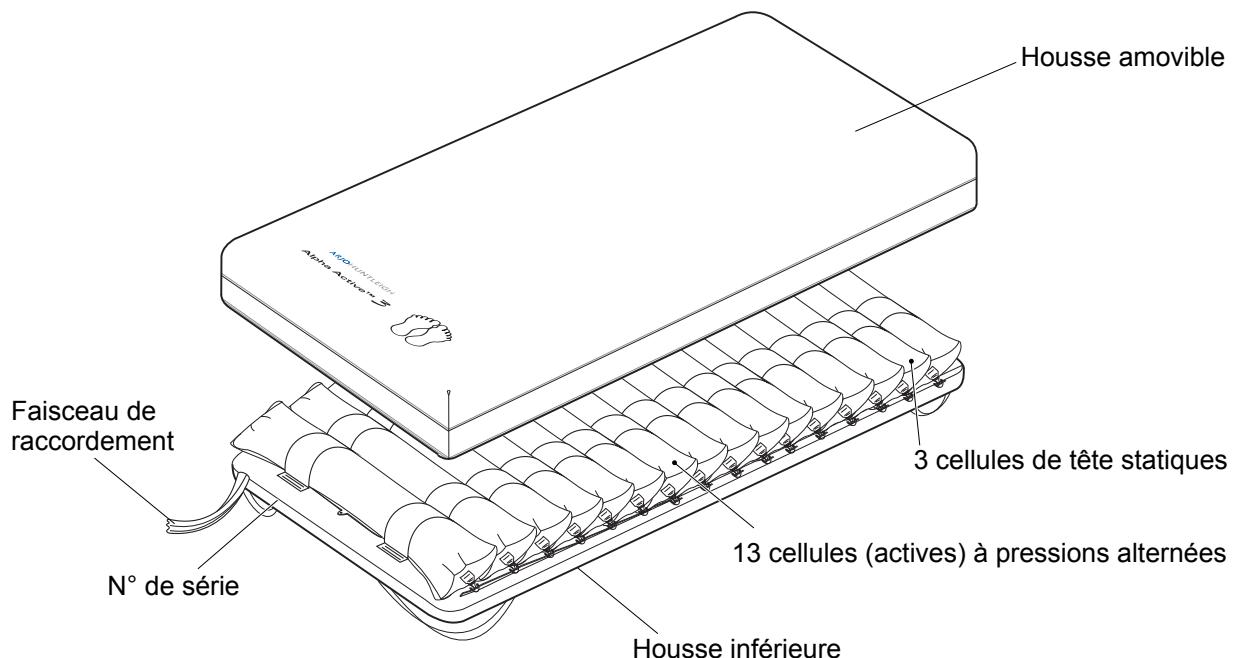
**Housse amovible** La housse standard est constituée d'un jersey enduit de polyuréthane extensible dans les deux sens et attaché avec une fermeture à glissière à une base résistante en nylon. Les fermetures à glissière sont protégées par des rabats pour prévenir la pénétration d'éléments contaminants et permettre le retrait de la housse pour le nettoyage.
