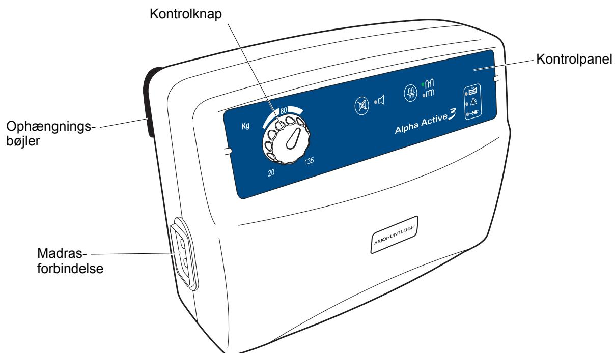
Kontrolknapperne sidder på forsiden af pumpen, og et avanceret alarmsystem skelner mellem normale og ægte systemfejl under anvendelsen. Hvis en alarmsituation registreres, lyser en indikator på forsiden af pumpen, og der lyder en advarselslyd.
