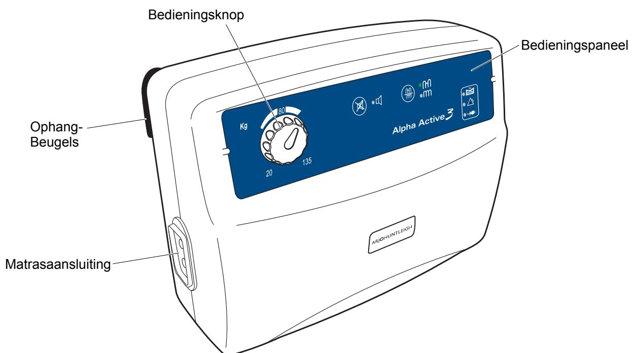
De bedieningselementen bevinden zich aan de voorkant van de pomp. Een geavanceerd alarmsysteem maakt onderscheid tussen een normale werking en mogelijke defecten in het systeem. In geval van een alarmsituatie gaat er aan de voorkant van de pomp een indicatielampje branden en wordt er een waarschuwingssignaal afgegeven.
