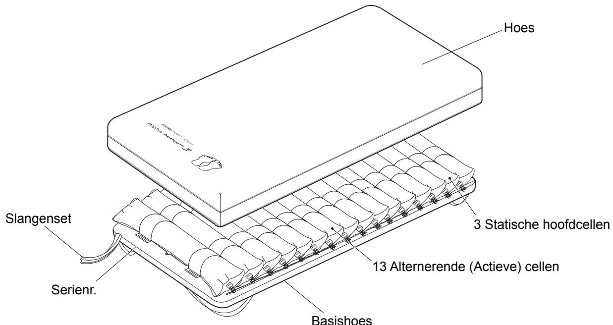
**Afneembare hoes** De standaardhoes bestaat uit een tweezijdig rekbaar stof met een coating van polyurethaan dat aan een duurzame nylonbasis is vastgeritst. De ritsen worden door flappen bedekt tegen het binnendringen van verontreinigende stoffen en zorgen ervoor dat de hoes eenvoudig verwijderd kan worden voor reiniging.
