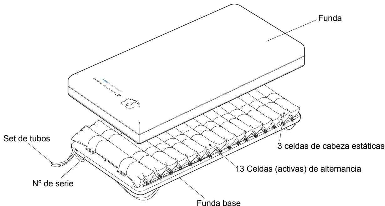
**Funda extraíble** La funda estándar consta de un tejido recubierto de poliuretano con elasticidad bidimensional abrochado mediante cremallera a una resistente base de nylon. Las cremalleras van protegidas por solapas para impedir la entrada de contaminantes y facilitar la extracción de la funda para su limpieza.
