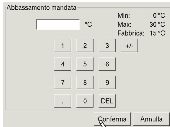
Inserire la nuova differenza di temperatura per l'"abbassamento mandata". Dalla curva termica "ON Giorno" meno l'"abbassamento mandata" ha origine la curva termica "ON Notte".
