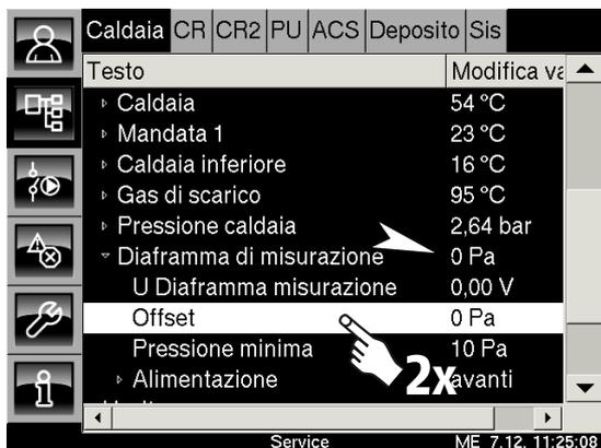
Se viene visualizzato un valore diverso, è necessario calibrare la misurazione.
