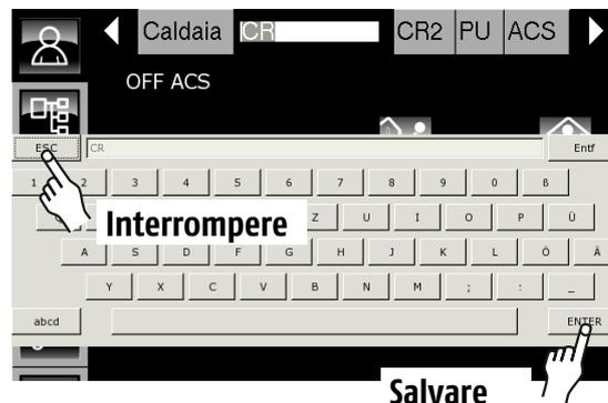
Con la tastiera inserire il nuovo nome per il circuito di riscaldamento, in questo esempio: PIANTERRENO.
