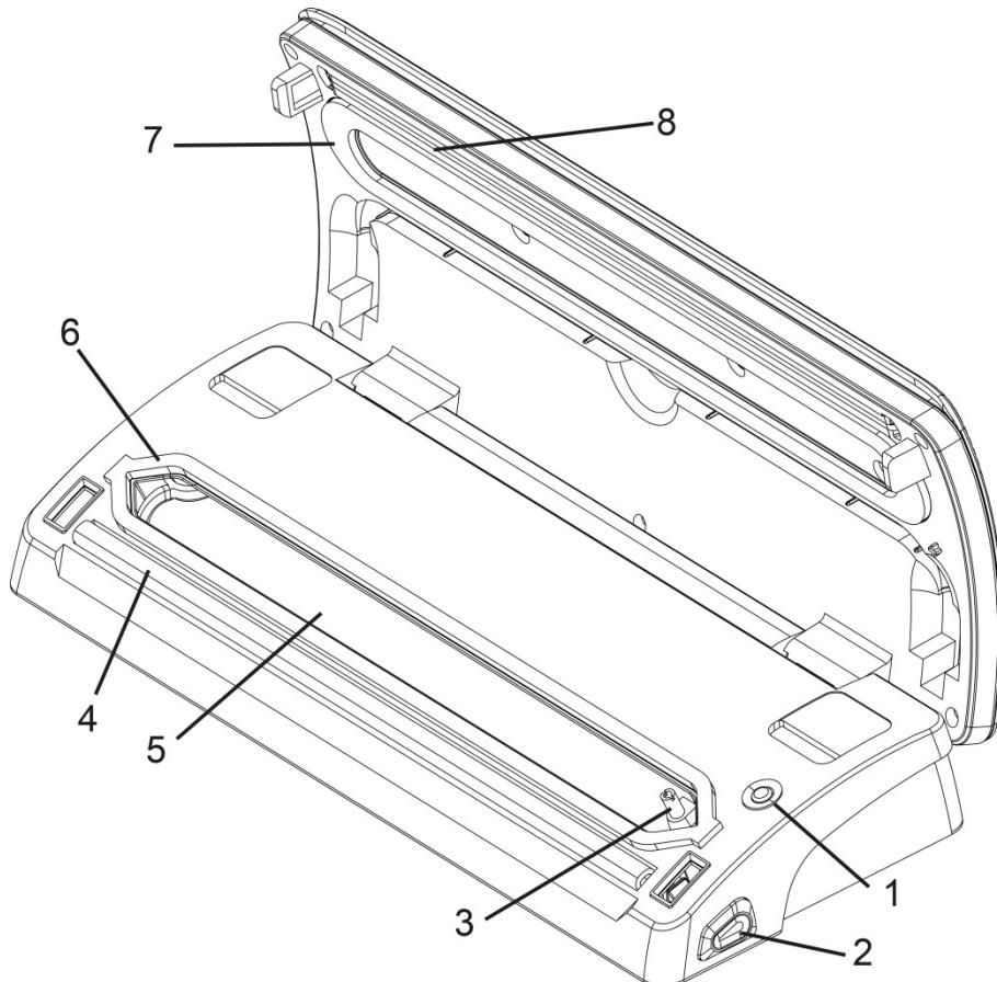
**5 Cámara de vacío:** Coloque el extremo abierto de la bolsa en la cámara. El aire es aspirado de la bolsa y el líquido de la bolsa queda recogido.
