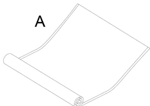
3. Nettoyez et défroissez le côté ouvert du sac et assurez-vous qu'il n'y ait ni pli ni repli sur la surface du côté ouvert. Placez un côté du sac sur le joint en caoutchouc (4) et le joint inférieur (6). Le côté ouvert du sac ne doit pas être placé dans
