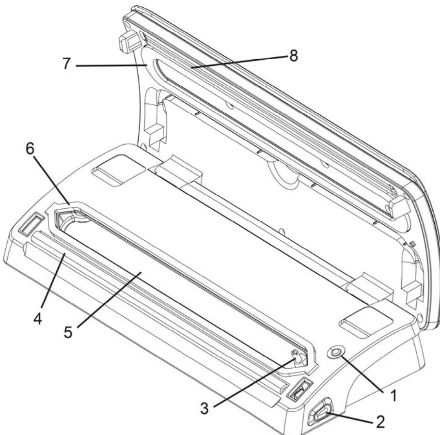
**1 Sicherheits-Schalter:** Wird bei geschlossenem Deckel ausgelöst.
