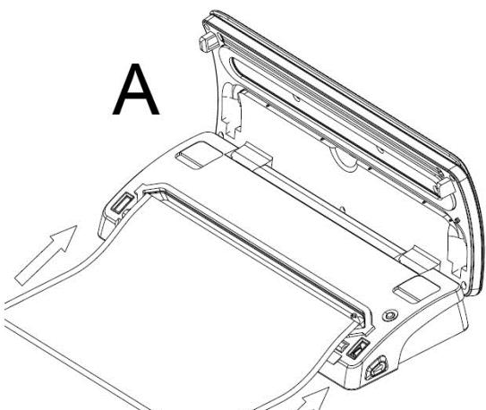
3. Coloque la bolsa como se muestra en la ilustración (A) en la cámara de vacío (5). La bolsa no debe colocarse sobre la tubuladura de aspiración (3), ya que de lo contrario no podría generarse
