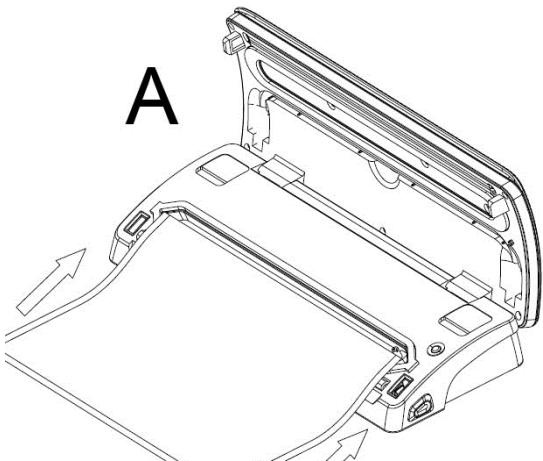
3. Legen Sie den Beutel wie auf der Abbildung (A) zu sehen in die Vakuumkammer (5). Der Beutel darf nicht über den Ansaugstutzen (3) gelegt werden, da sonst das Vakuum nicht korrekt erzeugt werden kann.
