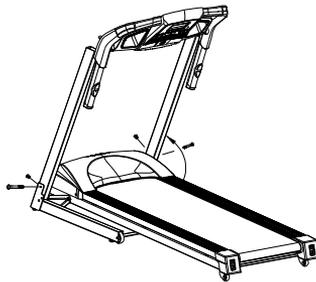
**Tappa n° 3:** sollevare la console più in alto possibile come mostrato qui di seguito. Utilizzare la vite M8\*15 per fissare la console a sinistra e a destra del montante verticale.
