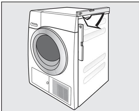
Per funzionare in modo ottimale, l'asciugabiancheria deve essere posizionata in bolla.
