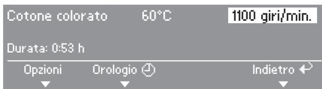
Ruotando il selettore si possono selezionare i diversi parametri del programma: programma, temperatura e velocità di centrifugazione. Il parametro selezionato risulta evidenziato. Premendo il selettore, si apre il sottomenù relativo al parametro selezionato.
