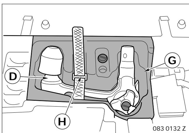
Inserire il dispositivo di alloggiamento **G** nello spazio libero sotto la copertura del bagagliaio.
