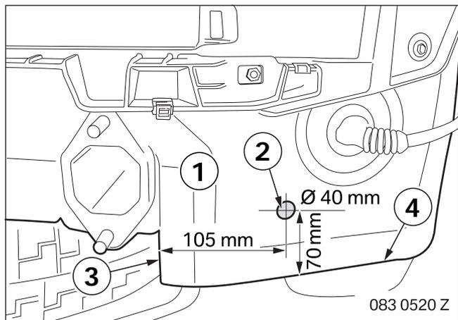
Segnare le misure sulla lamiera terminale posteriore (1) nel seguente modo e bulinare nel punto da forare (2):
