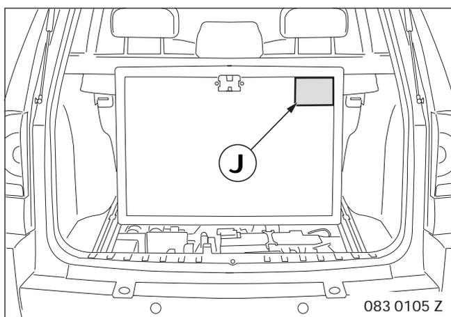
Incollare la targhetta istruzioni **J** sul lato inferiore del rivestimento del bagagliaio.
