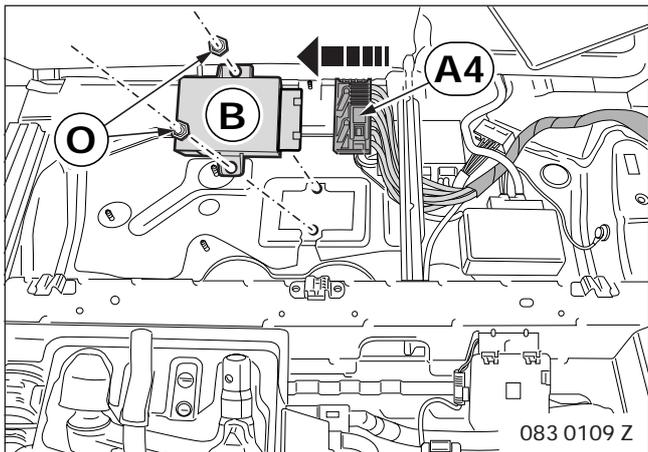
Collegare il modulo rimorchio **B** con i dadi di plastica **O** al perno con filettatura a passo grosso esistente e collegare la derivazione **A4**.
