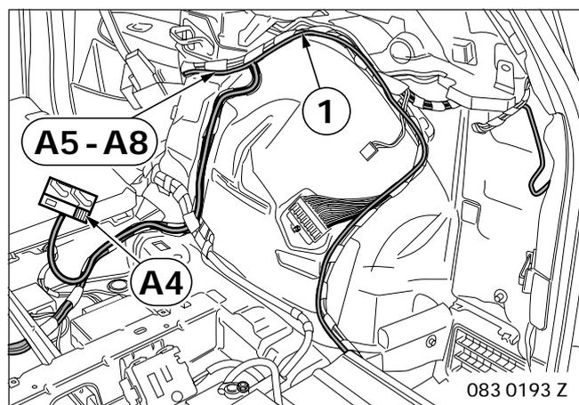
Posare la derivazione **A4** lungo il fascio di cavi della vettura (**1**) sotto il rivestimento anteriore del fondo del bagagliaio.
