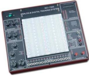
Include le funzioni essenziali per eseguire le esperienze di elettronica analogica e digitale. Breadboard rimuovibile. Alimentazioni cc fisse e variabili, potenziometro, generatore di funzioni, n. 2 strumenti digitali display LED 7 segmenti, TWO PULSE SWITCH, 16 switches dati; Altoparlanti; Adattatore 4 canali; 16 BITS LED DISPLAY
