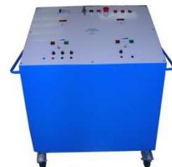
Per entrambi i modelli la tensione in uscita in c.c. regolabile da 0 a 250 V ; in alternata trifase regolabile da 0 a 400 V con possibilità di uso in monofase.
