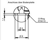
Achten Sie darauf, dass die Druckluft trocken, gefiltert (40µm) und geölt ist.
