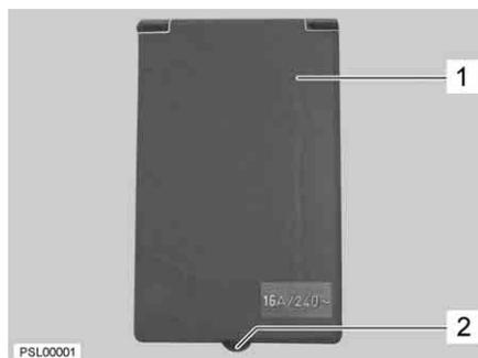
Fig. 4 Sportello esterno collegamento a 230 V
