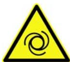
In caso di avviamento automatico del ventilatore durante i lavori di manutenzione sussiste il rischio di schiacciamento per dita e mani.
