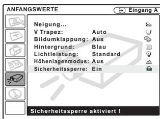
**5** Die Sicherheitssperre wird wirksam, wenn nach ihrer Aktivierung die Hauptstromversorgung ausgeschaltet und das Netzkabel abgezogen wird. Beim nächsten Einschalten des Projektors wird der Bildschirm für die Passworteingabe angezeigt.
