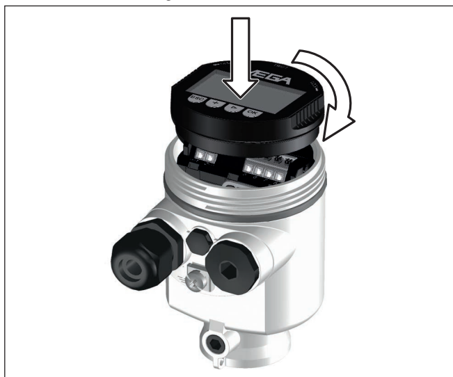
Figura 19: Inserimento del tastierino di taratura con display nel vano dell'elettronica in caso di custodia ad una camera
