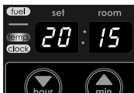
G: A sinistra la temperatura desiderata, a destra la temperatura misurata.
