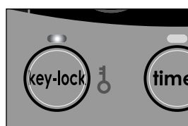
I: Se la spia luminosa KEY-LOCK si accende, è stato attivato il dispositivo di sicurezza.
