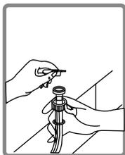
**⚠ AVVERTENZA:** i filtri delle valvole di carico dell'acqua possono ostruirsi a causa di acqua di rubinetto sporca o, di una manutenzione non adeguata. Ciò può portare a un guasto delle valvole, che può causare un afflusso d'acqua nell'apparecchio. I guasti dovuti a queste cause non sono coperti dalla garanzia.
