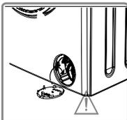
L'apparecchio è provvisto di un sistema filtrante che impedisce ai fili staccatisi dai capi e ad altri materiali di piccole dimensioni di entrare nella pompa durante le operazioni di scarico dell'acqua alla fine del lavaggio, prolungando così la durata di vita della pompa. Si raccomanda di pulire il filtro della pompa ogni 2 mesi.
