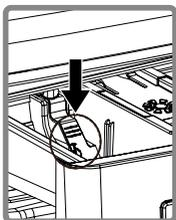
Con il tempo, è possibile che si accumulino residui di detersivo nella vaschetta e nel relativo alloggiamento. Per eliminare questi residui, smontare periodicamente la vaschetta del detersivo. Si raccomanda di pulire il filtro della pompa ogni 2 mesi.
