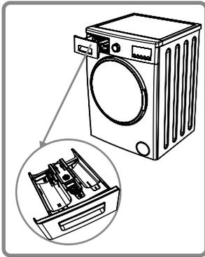
Per eseguire il lavaggio con un detersivo liquido, è possibile utilizzare l'apposito inserto per detersivo liquido\*. Il detersivo liquido può essere utilizzato in tutti i programmi senza prelavaggio. Disporre l'inserto per detersivo liquido (disponibile all'interno dell'apparecchio) nel secondo scomparto della vaschetta del detersivo (\*) e versare la dose di detersivo appropriata (per il dosaggio del detersivo liquido seguire le indicazioni del produttore).
