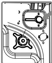
I filtri impediscono allo sporco e ai corpi estranei di penetrare nell'apparecchio e sono disposti nel tubo di afflusso dell'acqua, sia sul lato del rubinetto che su quello delle valvole di ingresso dell'acqua.
