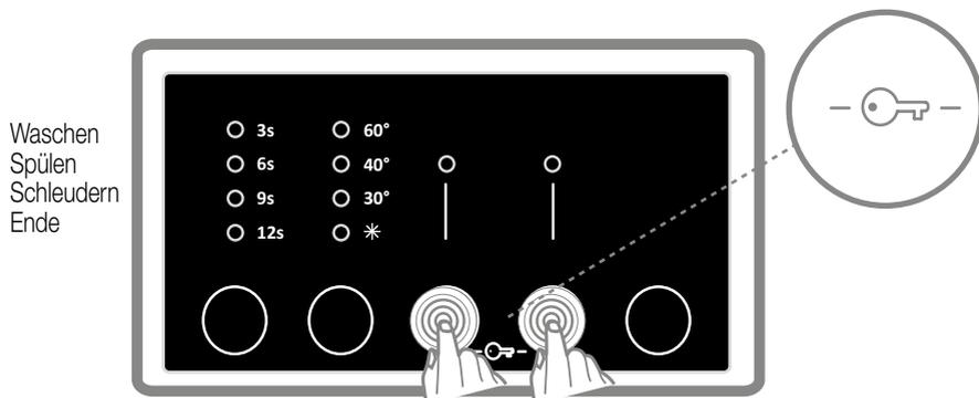
Una volta attivato il blocco di sicurezza, la pressione di un tasto farà lampeggiare i LED delle funzioni aggiuntive sul display.
