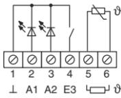
Binärausgänge A1, A2: LED oder elektronische Relais an Klemmleiste zwischen Klemmen 1 und 2...3 anschließen. Fernfühler zwischen Klemmen 5 und 6 anschließen.
