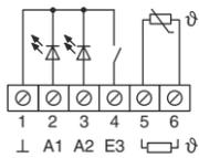
Uscite binarie A1, A2: collegamento LED o relè elettronico alla fila di morsetti tra i morsetti 1 e 2...3. Collegamento del sensore remoto tra i morsetti 5 e 6.
