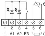
Sorties binaires A1, A2 : Raccorder LED ou relais électronique à la borne plate entre bornes 1 et 2...3. Raccorder le télécapteur entre les bornes 5 et 6.
