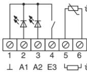
Binaire uitgangen A1, A2: Sluit LED of elektronisch relais aan de contactstrip tussen de klemmen 1 en 2...3 aan. Sluit de sensor op afstand tussen de klemmen 5 en 6 aan.
