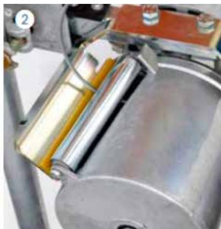
**2.** Il motore viene arrestato quando si allenta la fune, rimanendo così ben tesa nel tamburo
