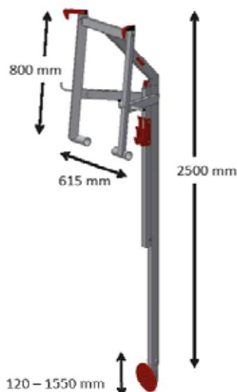
La mensola ad aggancio è la struttura verticale del sistema RSS. Va in appoggio nel canale e tramite il braccio telescopico viene appoggiato alla parete della casa. Importante: in caso di usura, i componenti in rosso devono essere sostituiti. (es. deterioramento da raggi UV, rottura, ecc.)
