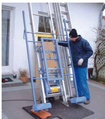
La **piattaforma per pannelli** è ottimale per trasportare elementi ingombranti come pannelli in cartongesso o infissi. Per agevolare lo scarico dei pannelli è possibile installare un carrello ribaltabile invece di quello standard. Il **carrello ribaltabile** porta automaticamente la piattaforma in posizione orizzontale nel punto di finecorsa.
