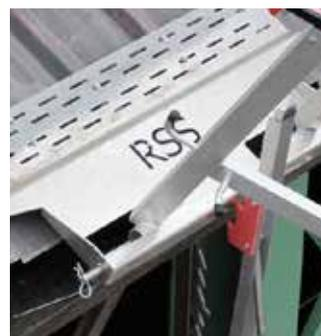
Il parapetto Roof Safety System è un prodotto innovativo nei sistemi di protezione collettiva. Interamente in alluminio, è certificato secondo la normativa europea UNI EN 13374 classe C, che permette un utilizzo su coperture fino a 60° di pendenza. È composto da una ringhiera da 3 metri di lunghezza, mensole e una tavola fermapiEDE, quindi non necessita di tavole aggiuntive.
