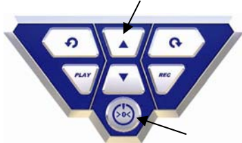
Abb. 11: Bedienfeld VIS 240 / 340: Mit Pfeil markierte Tasten gleichzeitig drücken
