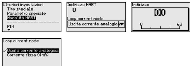
La regolazione di laboratorio è "*Uscita corrente analogica*" e l'indirizzo è 00.
