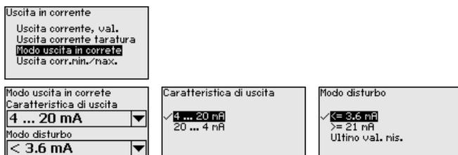
La regolazione di laboratorio è: caratteristica di uscita 4 ... 20 mA e modo disturbo < 3,6 mA.
