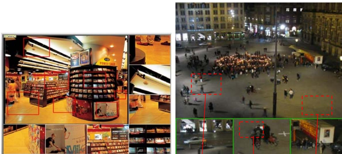
Figura - possibilità di definire fino a 7 zone ingrandite digitalmente per un controllo facile e immediato di ampie aree da video sorvegliare anche con una sola telecamera
