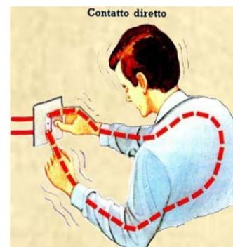
o un solo filo scoperto o qualsiasi elemento in tensione si verifica lo stesso fenomeno sopra specificato; in tale caso la corrente elettrica passa dall'elemento in tensione attraverso il corpo umano a terra.
