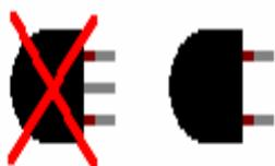
Gli apparecchi elettrici di Classe II **non** devono essere collegati all'impianto di terra in quanto la protezione è affidata a un doppio isolamento o a un isolamento rinforzato. Per riconoscerli basta guardare la targa: deve essere riportato il simbolo in figura.
