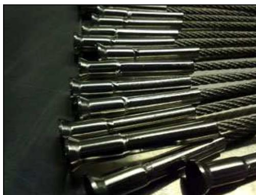
La lavorazione dei terminali avviene con procedimento di martellatura rollata a freddo, per ottenere la massima efficienza nella tenuta, e nello stesso tempo, una finitura esteticamente gradevole.
