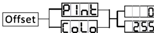
Per accedere al sotto-menù di regolazione offset, premere il pulsante ENTER per almeno 5 secondi. In questo sottomenù è possibile regolare la posizione home di rotazione e ruota gobo.
