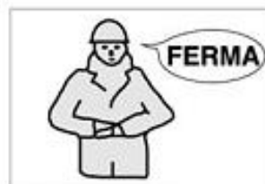
FINE (delle operazioni) Le due mani sono giunte all'altezza del petto.
