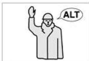
ALT (interruzione - fine del movimento) Il braccio destro è teso verso l'alto, con la palma della mano destra rivolta in avanti.
