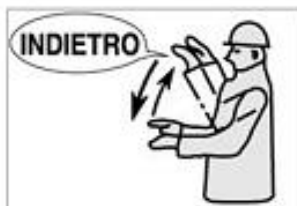
RETROCEDERE Entrambe le braccia sono piegate, le palme delle mani rivolte in avanti; gli avambracci compiono movimenti lenti che si allontanano dal corpo.
