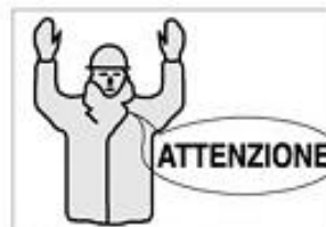
PERICOLO (alt o arresto di emergenza) Entrambe le braccia tese verso l'alto; le palme delle mani rivolte in avanti.
