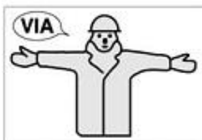
INIZIO (attenzione presa di comando) Le due braccia sono aperte in senso orizzontale, le palme delle mani rivolte in avanti.
