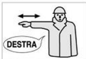
A DESTRA (rispetto al segnalatore) Il braccio destro, teso più o meno lungo l'orizzontale, con la palma della mano destra rivolta verso il basso, compie piccoli movimenti lenti nella direzione.
