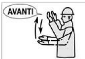
AVANZARE Entrambe le braccia sono ripiegate, le palme delle mani rivolte all'indietro; gli avambracci compiono movimenti lenti in direzione del corpo.
