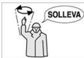
SOLLEVARE Il braccio destro, teso verso l'alto, con la palma destra rivolta in avanti, descrivere lentamente un cerchio.
