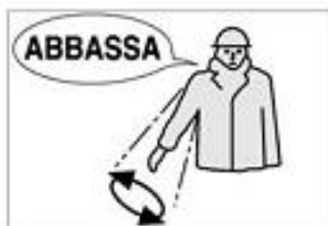
ABBASSARE Il braccio destro, teso verso il basso, con la palma della mano destra rivolta verso il corpo, descrivere lentamente un cerchio.
