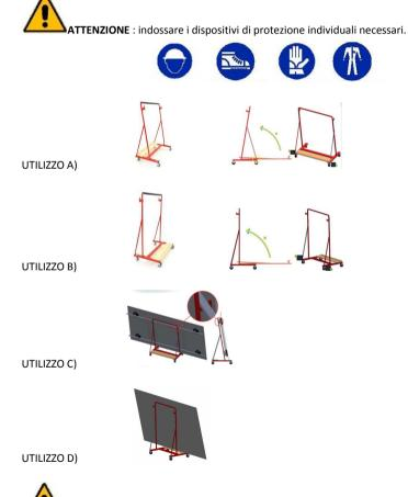
**ATTENZIONE**: CONTROLLARE L'INTEGRITA' DELLE RUOTE E IL SERRAGGIO DEI PERNI DEL CARRELLO
