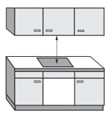
Tra il piano di cottura e la cappa aspirante soprastante si dovrà mantenere la distanza di sicurezza indicata dal produttore della cappa. Se mancano le indicazioni o se sopra il piano di cottura si trovano materiali facilmente infiammabili, ad es. un pensile, si dovrà mantenere una distanza minima di sicurezza di 760 mm.
