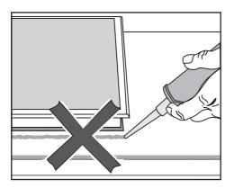
Se si rende necessario togliere il piano di cottura dal vano d'incasso, il piano di cottura e quello di lavoro possono rimanere danneggiati se il piano di cottura viene sigillato con mastice. Non usare quindi mastice speciale per fughe per fissare il piano di cottura a quello di lavoro. La guarnizione sotto il bordo superiore dell'apparecchio garantisce una sufficiente isolazione col piano di lavoro.
