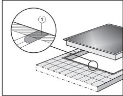
Le fughe ① e lo spazio tratteggiato sotto la superficie di appoggio dell'apparecchio devono essere lisci e in piano per garantire una perfetta aderenza in modo che la guarnizione sotto il bordo superiore dell'apparecchio isoli adeguatamente l'apparecchio dal piano di lavoro.
