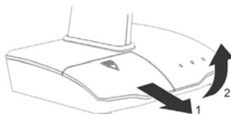
2 Ta nu ut de fulladdade batterierna ur sändarens laddfack och sätt i dem i mottagaren. Öppna batterifacket genom att regla upp låset och lägg i de fulladdade batterierna. Se till att de ligger åt rätt håll (följ märkningen i batterifacket). Stäng batterifacket.
