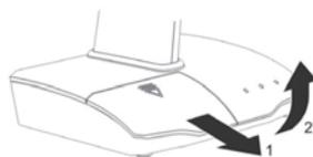
2 Sortez maintenant les accumulateurs complètement chargés du compartiment de chargement de l'émetteur et insérez-les dans le récepteur. Ouvrez le compartiment des accumulateurs en desserrant le verrouillage et insérez les accumulateurs complètement chargés. Attention à la bonne polarité (marquage dans le compartiment des accumulateurs). Refermez le compartiment des accumulateurs.
