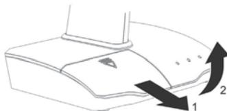
2 Neem nu de opgeladen batterijen uit het laadvak van de zender en leg ze in de ontvanger. Open het batterijvak door de vergrendeling ervan te openen, en leg de opgeladen batterijen erin. Let op de juiste polariteit (gemarkeerd in het batterijvak). Sluit het batterijvak.
