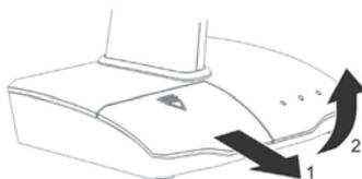
2 Togliere ora le batterie completamente cariche dallo scomparto di carica dell'emittente e inserirle nel ricevitore. Aprire lo scomparto batterie sbloccandolo e inserire le batterie cariche. Prestare attenzione alla corretta polarità (etichettatura nello scomparto batterie). Richiudere lo scomparto batterie.
