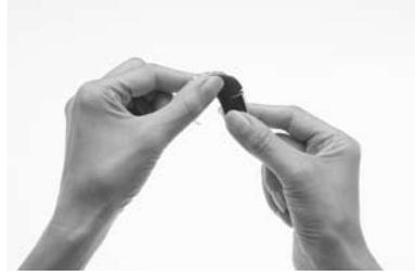
1. Tenere il modulo della batteria e l'unità di elaborazione in modo tale che siano a contatto. Il modulo della batteria deve essere posizionato a sinistra e l'unità di elaborazione a destra rispetto alla posizione finale.
