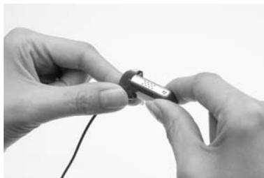
4. Tenere il modulo batteria e il connettore inferiore del cavo LiteWear (l'estremità del cavo che si collega al modulo batteria) in modo che entrino in contatto. Il connettore deve essere posizionato a destra e il modulo batteria a sinistra rispetto alla posizione finale.
