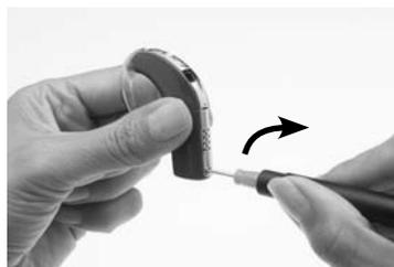
2. Aiutandosi con un cacciavite, ruotare delicatamente il blocco in senso orario finché è in posizione orizzontale.
