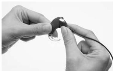
2. Tenere l'unità di elaborazione e il connettore del cavo LiteWear (l'estremità del cavo che si collega all'unità di elaborazione) in modo che entrino in contatto. Il connettore deve essere posizionato a sinistra e l'unità di elaborazione a destra rispetto alla posizione finale.
