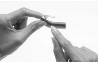
3. Assicurarsi che il modulo della batteria sia allineato in maniera corretta. Controllare che fra il modulo della batteria e l'unità di elaborazione non ci siano contatti rotti o piegati che possano causare un allineamento scorretto. Contattare la propria clinica nel caso in cui i contatti fossero piegati o rotti.
