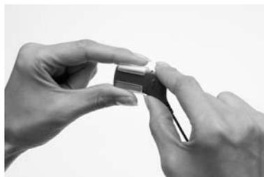
3. Inserire il modulo batteria nella custodia LiteWear premendo delicatamente l'estremità del connettore. Il modulo batteria può venire inserito nei due versi.
