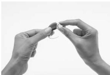
5. Sostituire le batterie usa e getta con delle nuove.
