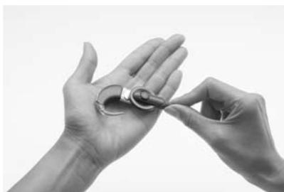
1. Posizionare il magnete della bobina sulle batterie, in modo tale che sia a contatto con entrambe. Il magnete della bobina estrarrà le due batterie dal contenitore.
