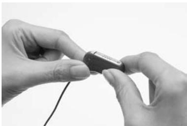
1. Fissare il cavo LiteWear al modulo batteria.
