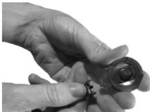
1. Tenere la bobina e il cavo della bobina mantenendo la parte inferiore della bobina verso l'alto. Premere con l'unghia tra la bobina e il cavo della bobina, sulla parte inferiore della bobina, per facilitare la rimozione del cavo dalla bobina.
