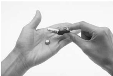
3. Rimuovere le batterie usa e getta (batterie zinco-aria) dal contenitore delle batterie.
