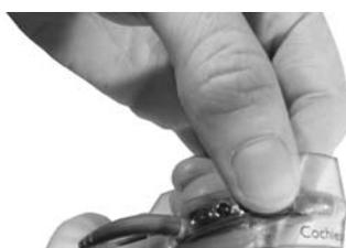
9. Premere con il pollice sulle cover del microfono, una alla volta, finché le cover del processore si inseriscono nei fori del microfono. Se inserita correttamente, la superficie superiore della cover del microfono deve essere in linea con la parte superiore dell'unità di elaborazione.
