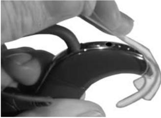
10. Rimuovere l'applicatore delle cover del microfono sollevandolo delicatamente dall'estremità del cavo della bobina.
