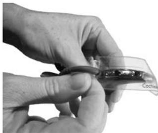
7. Far passare il cavo della bobina attraverso il foro superiore dell'applicatore delle cover del microfono.
