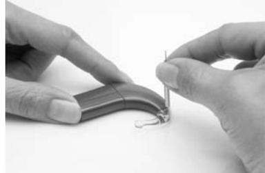
1. Fissare la curvetta con bloccaggio all'unità di elaborazione, prestando attenzione che il foro sulla curvetta sia allineato a quello sull'estremità della curvetta dell'unità di elaborazione.
