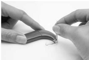
4. Premere lo spillo di inserimento della curvetta con lo strumento di inserimento della curvetta finché lo spillo non è completamente inserito. Assicurarsi che lo spillo non sporga dalla curvetta.
