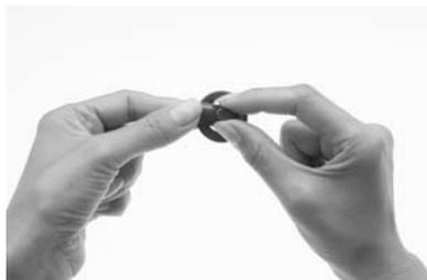
5. Inserire delicatamente il magnete nel rispettivo incavo, sulla parte superiore della bobina. La parte con la stella deve essere rivolta verso l'alto. Il magnete entra facilmente in sede.
