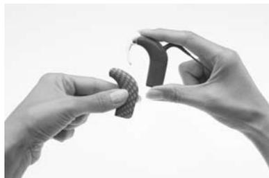
2. Estrarre la cover del processore facendola scorrere. Premendo con il pollice sulla parte inferiore del processore, risulterà più semplice far scorrere la cover verso il basso.
