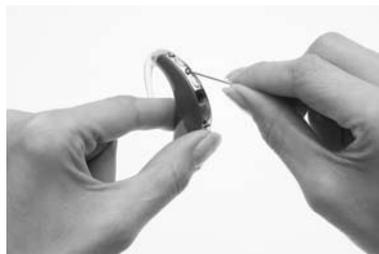
1. Tenere il processore in una mano e lo strumento per la rimozione delle cover del microfono (o l'ago/lo spillo) nell'altra.
