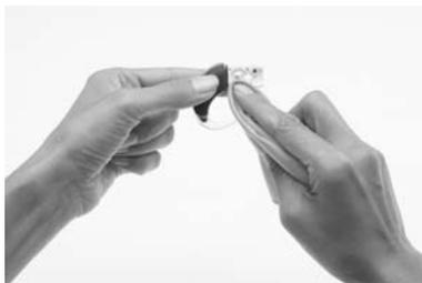
4. Pulire il contenitore delle batterie e la cover (internamente ed esternamente) con un panno morbido e asciutto per rimuovere acqua, umidità e sudore.
