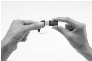
2. Rimuovere la cover della batteria dal contenitore delle batterie.
