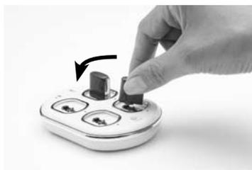
1. Rimuovere il modulo della batteria ricaricabile dall'unità di elaborazione.
