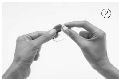
3. Per rimuovere le batterie, picchiettare con le dita sul lato del contenitore (1), o estrarre ciascuna batteria con le dita (2), come mostrato.
