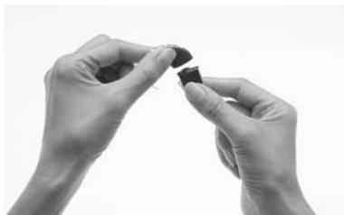
1. Se il modulo batteria è collegato all'unità di elaborazione, scollarlo dall'unità.
