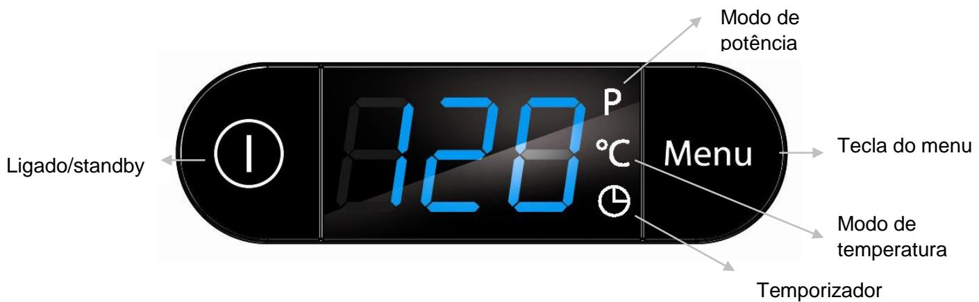
O visor destina-se à exibição da temperatura predefinida, nível de potência, hora do temporizador e, em caso de erro, à apresentação do código de erro.
