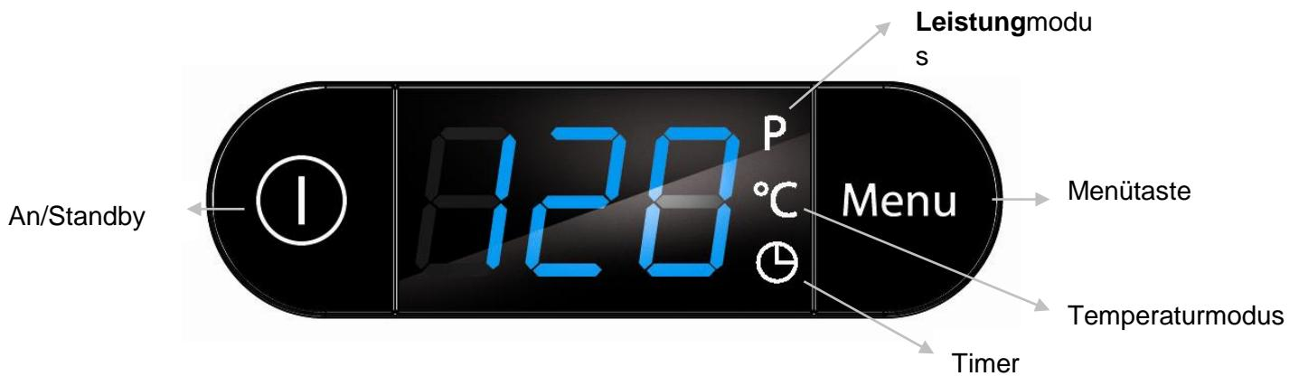
Das Display dient zur Anzeige der vorgewählten Temperatur, Leistungsstufe, der Timer-Zeit und im Fehlerfall zur Darstellung des Fehlercodes.
