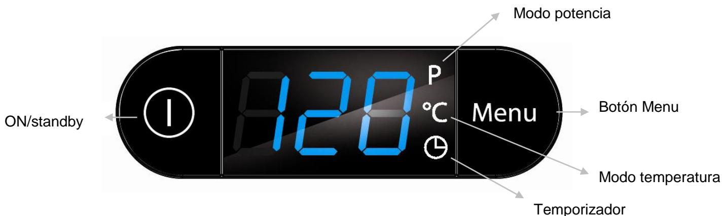
La pantalla sirve para mostrar la temperatura preseleccionada, el nivel de potencia, la hora de temporizador y, en caso de fallo, para representar el código de error.
