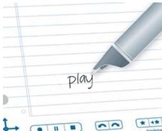
La funzionalità di completamento automatico consente di visualizzare il primo comando corrispondente al testo scritto. In questo caso il comando **"riproduci"** viene visualizzato non appena si scrive la lettera "r". Non appena il comando desiderato viene visualizzato sul display, è possibile cessare di scrivere.
