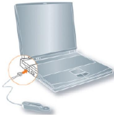
3. Inserire la smartpen Pulse nella base di ricarica mobile USB.
